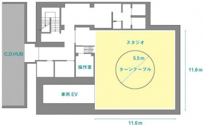
3面の大型スクリーンとして使用できる壁面と、自動車など大型の試作品を載せるターンテーブル、搬入用エレベーターを備えた、大型のバーチャルスタジオです。用途にあわせて、下記の設備を活用いただくことで、商品開発工程の効率化を実現します。
