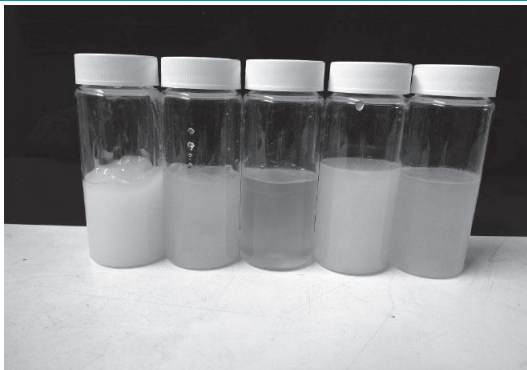
図2 シルクナノファイバー添加乳化物の外観 図3 3Dバイオプリンターによる造形物
