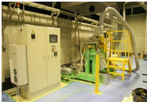
■ 材料作製: セルロース混合可塑化成形装置
