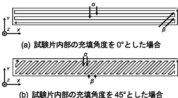
Fig. 1 試験片を作製する際の材料の充填角度の模式図
