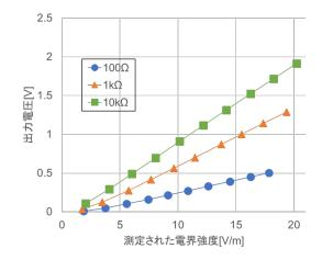
レクテナ(アンテナ+整流回路)の出力評価
