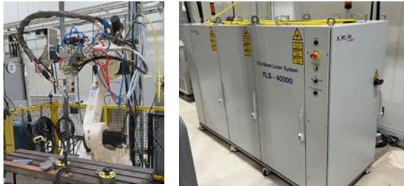
図1 ハイブリッド溶接試験装置 [40kWファイバーレーザ発振器 (YLS-40000-C、IPGフォトニクス)、レーザヘッド(FLW-D50、IPGフォトニクス、MIG電源(WB-P500L、ダイヘン)]
