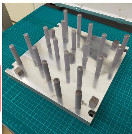
今後、粉末特性(粒度分布、化学成分etc.)をモニタリングしながら基準造形を複数回実施し、引張試験等により造形の再現性、粉末リサイクル、造形位置等の影響を見極めつつ、MPS構築に必要な情報を取得する
