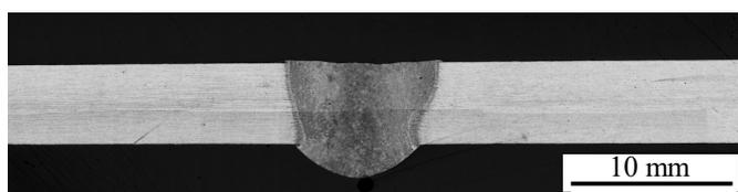
溶接部に割れの発生は認められなかった。一方、溶接部の最低硬さは母材の60~64%に低下した。
